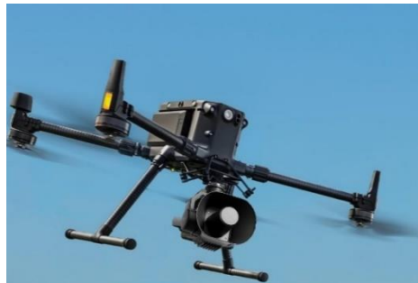
スピーカーを装着した無人航空機（ドローン）
